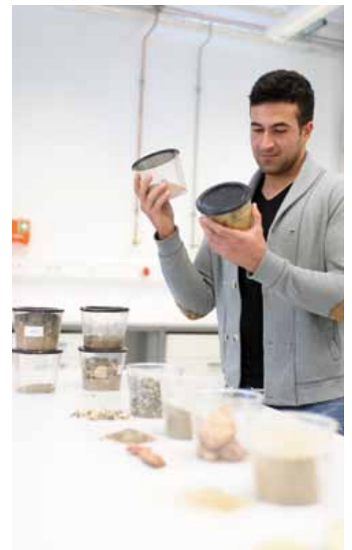
Jeder Boden ist anders. Um seine mechanischen Eigenschaften beurteilen zu können, sibt der Baustoffprüfer die Probe vorab per Hand. Das geht ab einem Korn Durchmesser von mehr als 0,063 Millimetern.
