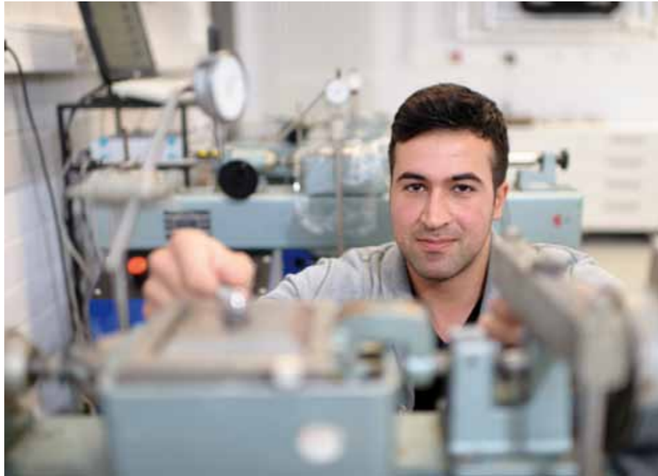
Bis zu welcher Neigung darf die Böschung gebaut werden? Hamed Najem bei einem Scherversuch, mit dem er die Bodenreibungskräfte ermittelt.
